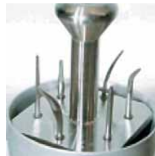
Рис. 10. Набор инструментов из высококачественной стали, с алмазным напылением и из комбинированных материалов.
